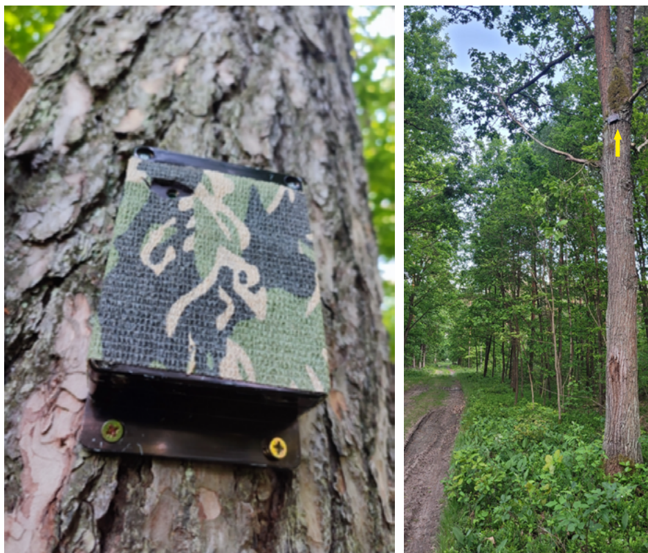
Ryc. 49. Rejestrator LunaMoth podczas pracy w terenie. Jeden z modeli rejestratorów stacjonarnych, które mogą być stosowane w monitoringu akustycznym nietoperzy (fot. Katarzyna Thor, Błażej Wojtowicz)
